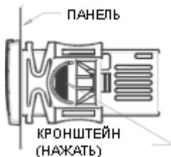
Приборы устанавливаются на вертикальную панель в отверстие размером 29x71 мм и крепятся специальным кронштейном, который входит в объем поставки. Правильность работы гарантируется при допустимом диапазоне температур 0 – 60°C. Необходимо принять меры, чтобы исключить установку прибора в местах, подвергаемых воздействию сильных вибраций, а также в местах, где выделяются агрессивные газы, накапливается пыль или влага.
