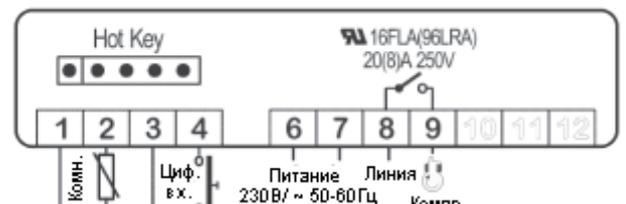
**ПРИМЕЧАНИЕ:** реле компрессора – 20(8)А или 8(3)А (в зависимости от модели)
