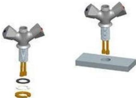
1. Снимите гайку, две прокладки с корпуса и вставьте корпус в предварительно просверленное отверстие.
