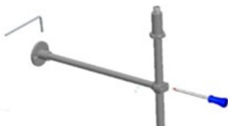
4. Вставьте штангу в две стороны настенного кронштейна, используйте шестигранный ключ, чтобы закрепить штангу на кронштейне. Прикрутите другую сторону после регулировки высоты настенного кронштейна.
