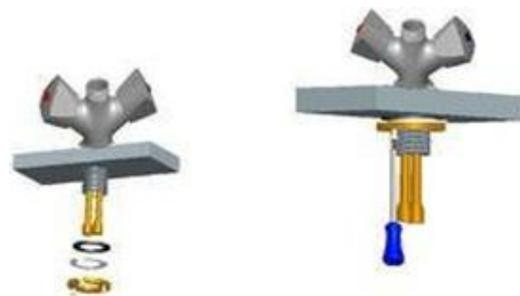
• Установка блока смесителя модели HKN-PRF03, HKN-PRF04:
