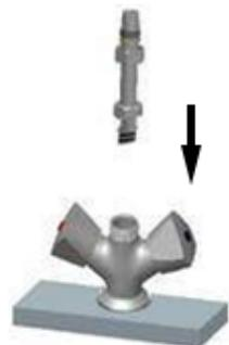
3. Соедините короткую стойку с корпусом, плотно закрутите стопорную гайку гаечным ключом.
